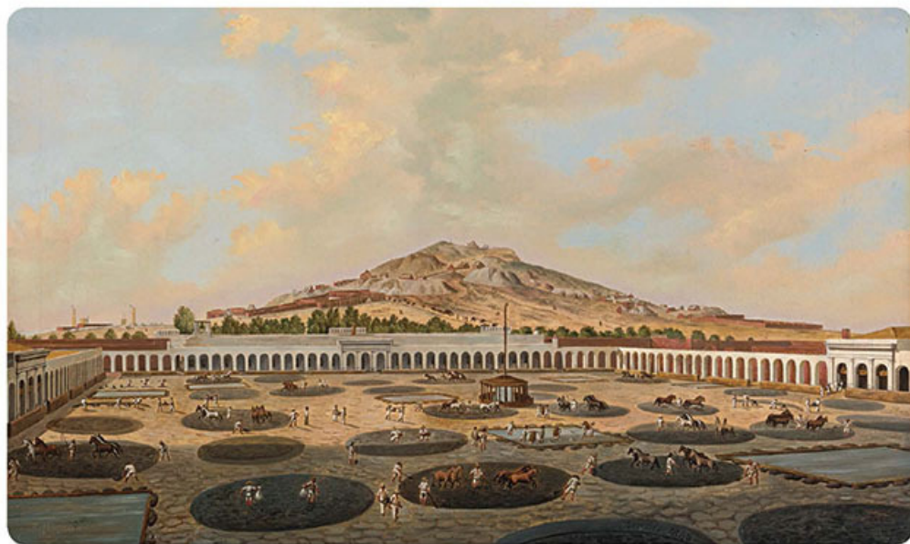
Figura 3.27 Hacienda Nueva de Fresnillo, reducción de plata mediante el proceso de patio. La extracción de plata en esta mina se remonta a 1550.
